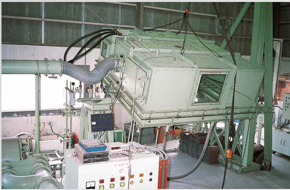
圧力箱式防水性能試験
