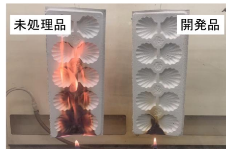
図2 防災パルプモールド壁紙の燃焼テスト
