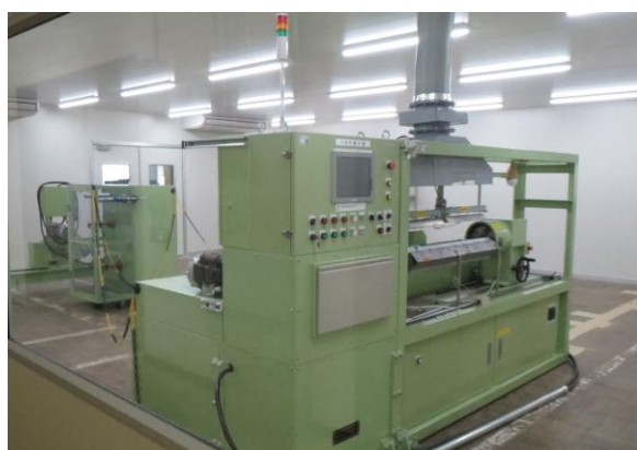
図 1 フィラメントワインディング装置
