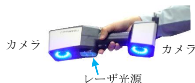
図 3 レーザ光投影式ハンディ型 3D スキャナ
