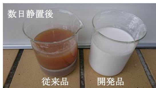
また、本開発品を塗布したセラミックスファイバーは従来品に比べ耐摩耗性が向上しており、対流によるセラミックスファイバーの飛散を抑制できます。0.3mm程度のコーティングにより、20m/sの風速にも耐えることができ、製品寿命の向上や作業現場の環境を改善することができます。
