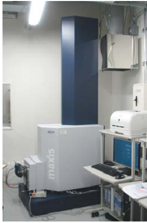
当センターに整備された 液体クロマトグラフ質量分析装置
