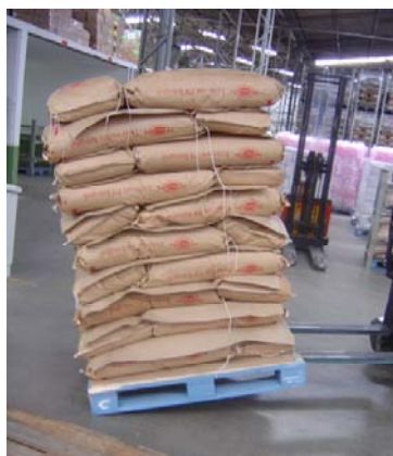
写真3 紙製滑り止めシートの使用事例
