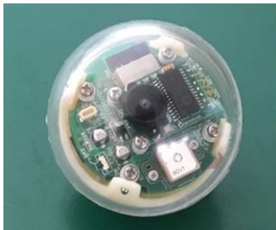
ドローン投下型センサーボール（直径 76mm）
