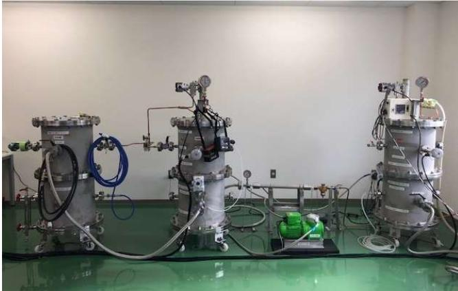
図4 回収副生水素精製設備
