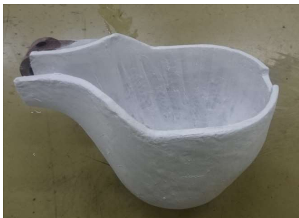
開発したコーティング材を塗布したラドル
