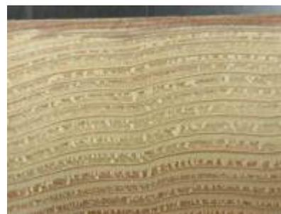
図4 表層のみを圧密化したスギ材断面
