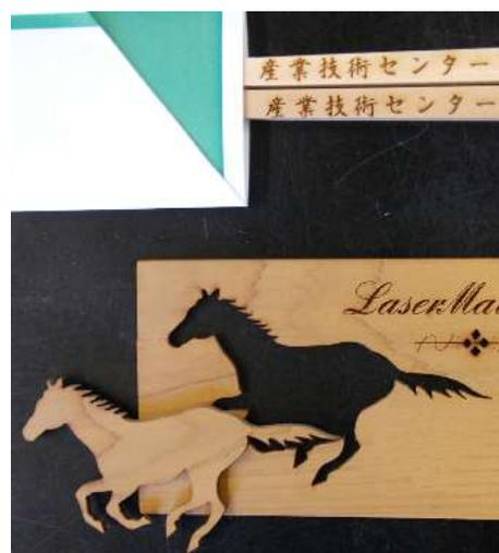
図1 炭酸ガスレーザーによる加工例
