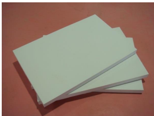
開発した耐火断熱ボード (600×900×50mm)
