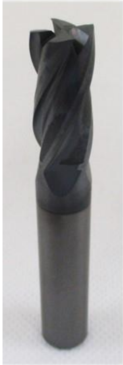
図4 金属 3D プリンターにて作製した超合金製の造形物
