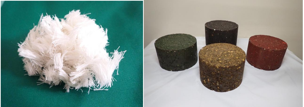
裁断した捨て耳（左）と開発した廃繊維添加常温アスファルト混合物（右）
