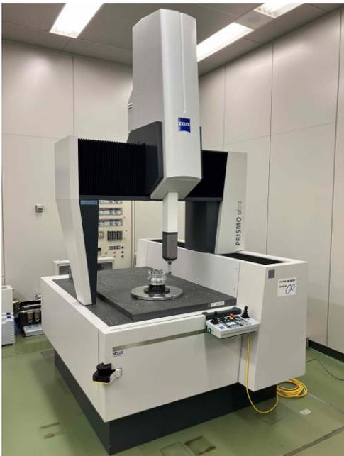
今回導入した接触式三次元測定機
