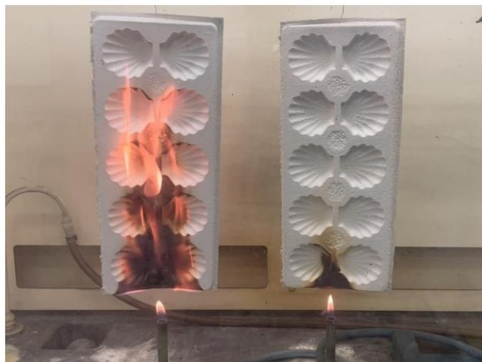
図3 燃焼試験の様子(左:従来品 右:開発品)
