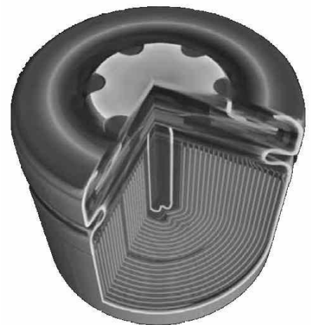
撮影例 リチウムイオン2次電池 内部構造観察
