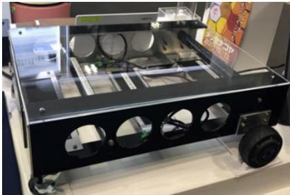
知の拠点あいち重点研究プロジェクトⅢ期<sup>※4</sup>「革新的マルチマテリアル接合による軽量・高性能モビリティの実現」の成果品。マルチマテリアル接合技術によって、CFRTP<sup>※5</sup>材料とアルミニウムを接合することで、AGV本体の骨格を構成しました。
