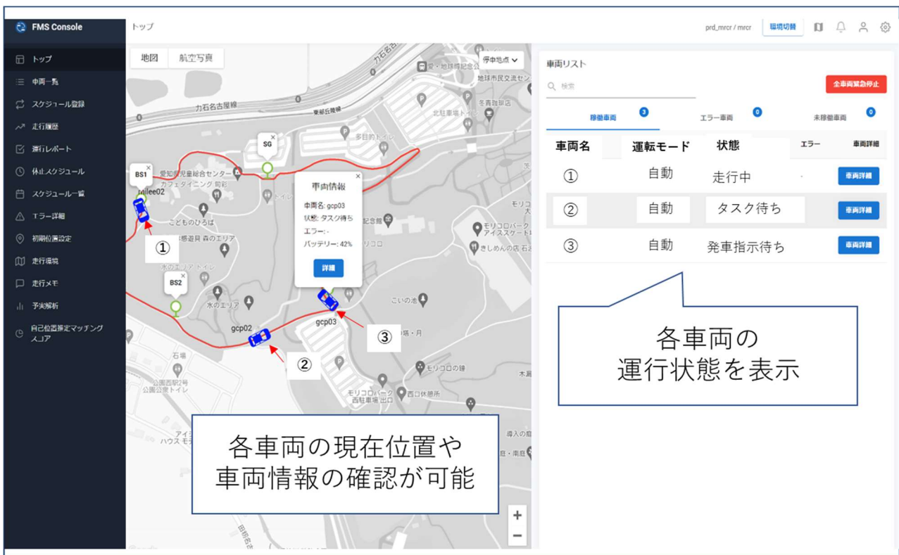
図1 FMS コンソール 配車管理画面
