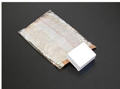
写真1 小型無線装置付き尿漏れ検出用センサ織物
