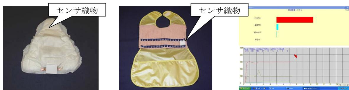
(A)尿採りパッドへの装着 (B)よだれかけへの装着 (C)尿漏れ検出システムの画面
