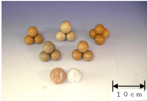
ブランコや滑り台からの落下による事故を防止するため、土に埋めて落下の衝撃を吸収するセラミックス製緩衝材を開発しました。
