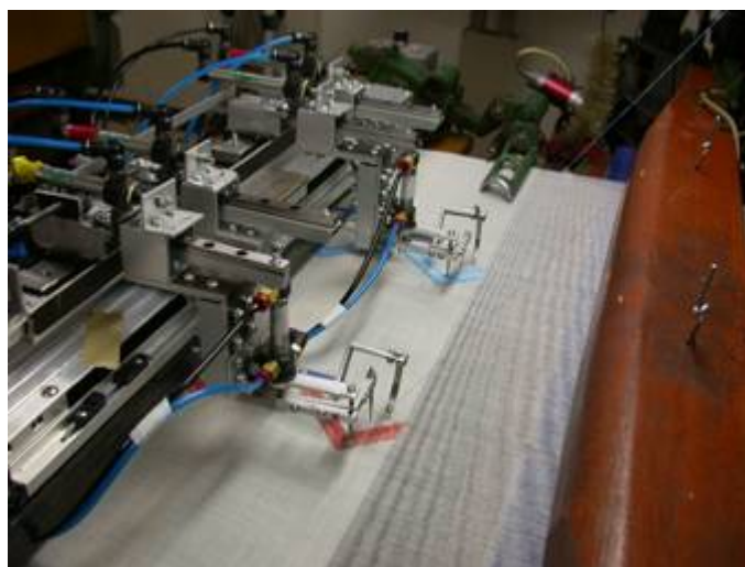
図6 開発した部分よこ糸挿入装置の写真
