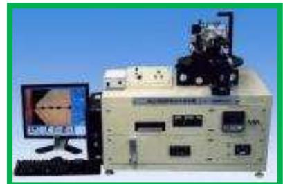
複合材界面特性評価装置 (マイクロドロプレット法)
