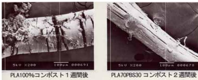
図6 電子顕微鏡写真
