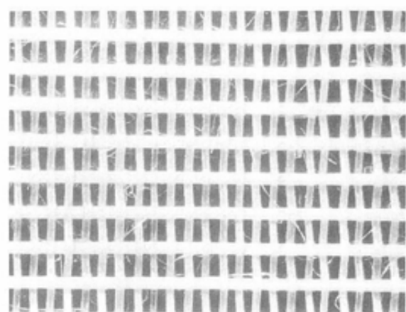
図14 ヨコ糸LCPの織布（タテ曲がり）
