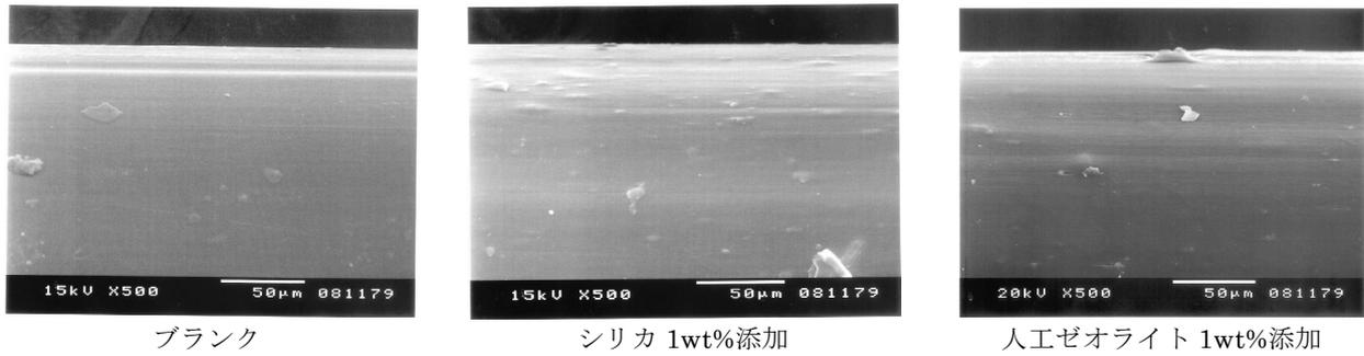
図1 芯鞘モノフィラメント表面電子顕微鏡写真 (500倍)
