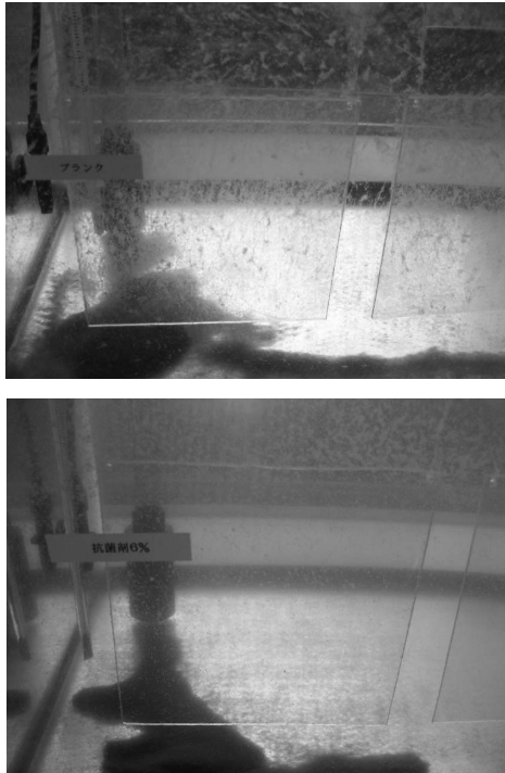
図7 水槽表面の着藻状況 (18日後) (上:ブランク、下:6%)
