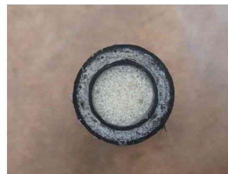
図7 中実二重円管構造 CFRTP
