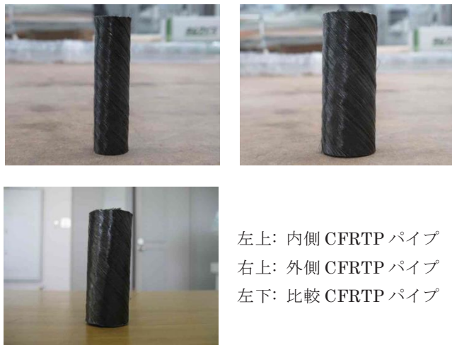
図5 多給糸 FW 法 CFRTP パイプ
