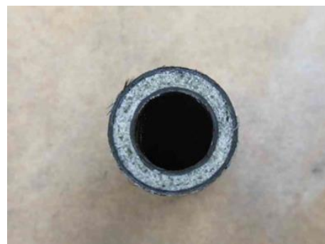
図6 中空二重円管構造 CFRTP
