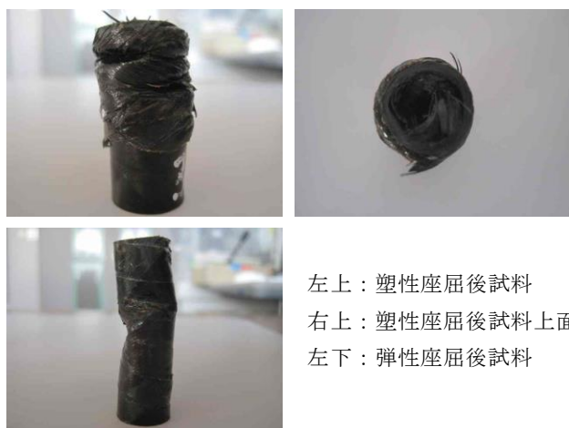
図2 単給糸FW法パイプ圧縮試験後
