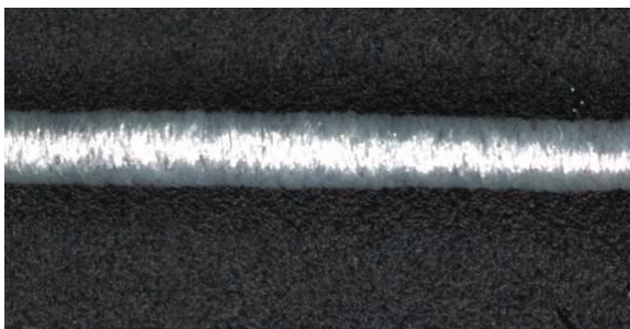
図1 カバリングCF複合糸 (No.2)
