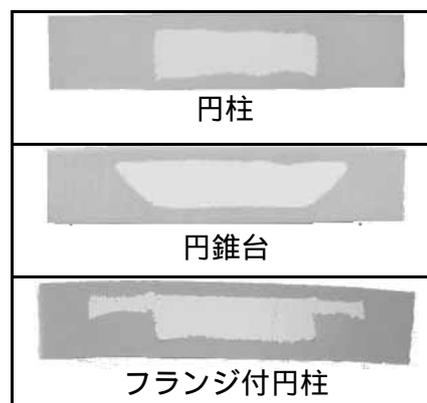
写真 熱橋形成タイルの切断面
