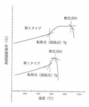
図4 釉薬の熱膨張曲線
