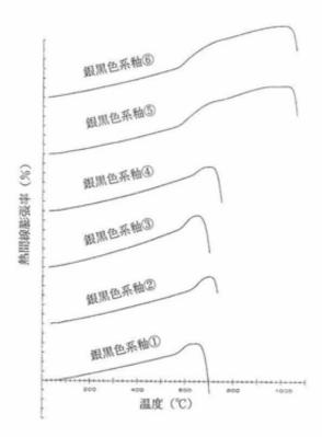
図2 銀黒色系釉薬の熱膨張曲線
