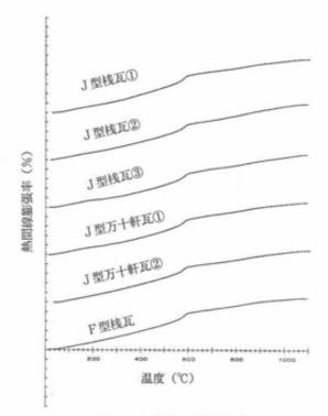
図3 瓦素地の熱膨張曲線
