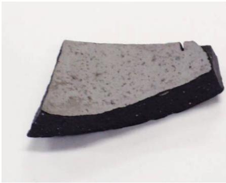
図4 試料A (24時間反応させた瓦)
