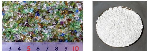
図4 廃ガラス破砕品（左）と微粉碎廃ガラス（右）
