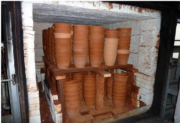
図10 植木鉢試作に使用したガス炉
