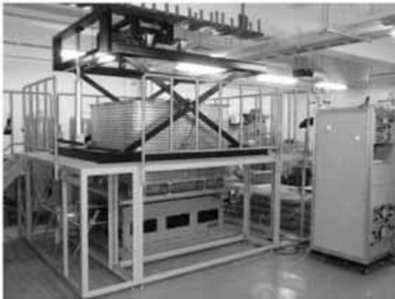
**図2** 地盤振動装置
