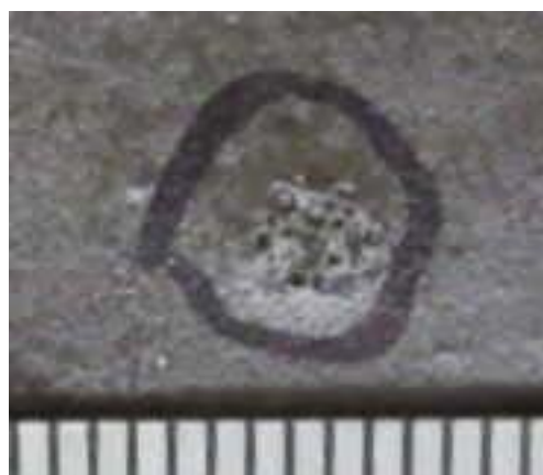
図 1 釉面に発生した発泡(目盛りは 1mm)
