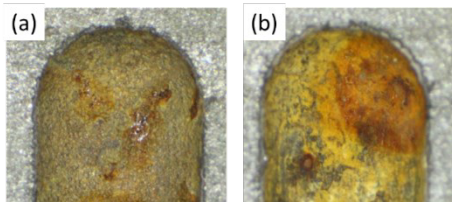
図 8 鑄造 10,671 ショット後の鑄抜きピン断面写真 (a)めっき処理有り、(b)めっき処理無し
