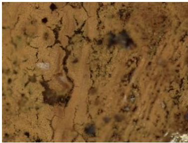
図 2 塩水浸漬試験後のデジタルマイクロスコブ像 (横 0.84mm×縦 0.63mm)
