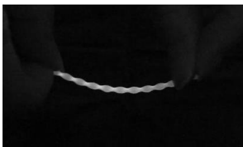
図3 微小ノード試料の変形による発光
