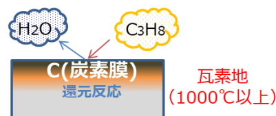
図 1 いぶし瓦の燻化反応の模式図
