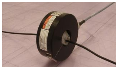
電流プローブによるケーブルを流れるノイズ電流の測定例
