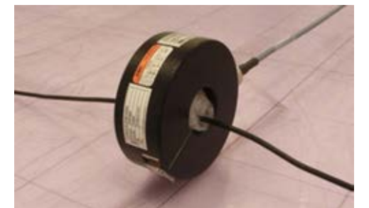
■ 電流プローブによる ケーブルを流れるノイズ電流の測定例
