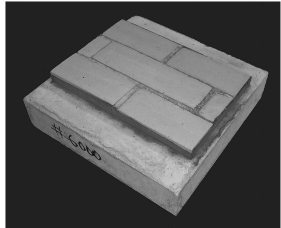
図2 コンクリート板上にモルタル貼りした試作タイル
