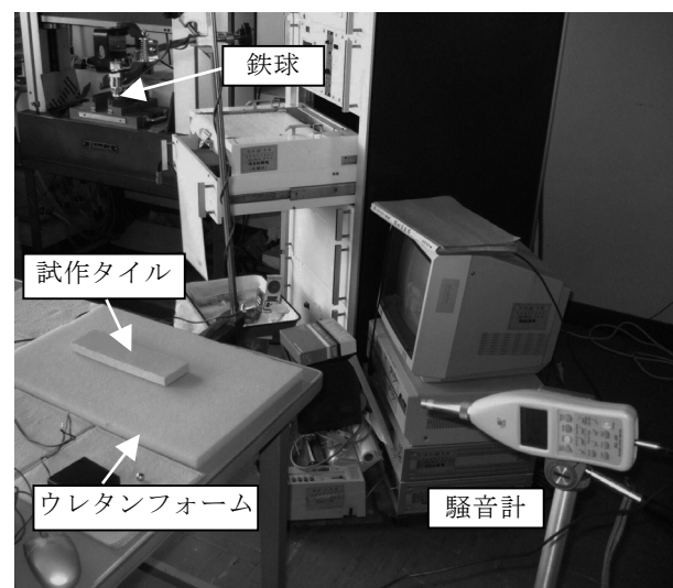
図 1 落球試験によるタイルの固体衝撃音測定装置
