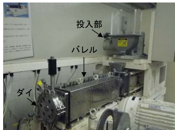
図1 2軸エクストルーダー (スクリューはバレルの中に存在)
