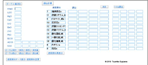
図4 簡易型釉薬調合計算システム画面
