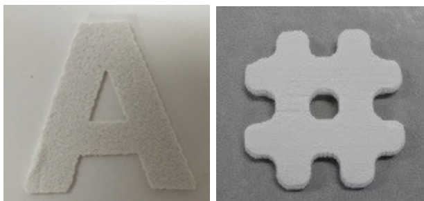
図2 レーザー加熱を用いた造形体
