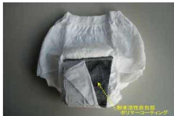
図8 本研究の粉末活性炭包括 PVA - PAA - PAM 系ポリマーゲルを適用した失禁用紙おむつ
