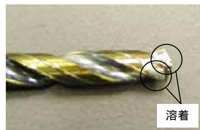
図5 アルミニウム合金が溶着したドリル
