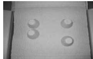
図 15 輸送試験後の緩衝材(底部)の状況
