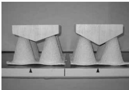
図 4 圧縮試験用の木製治具
