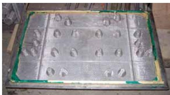
**写真1** 組付け式金型の例
